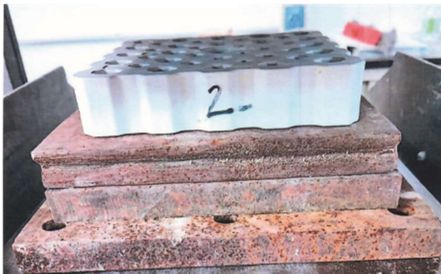
Prova 2 - modalità di applicazione del carico, il provino sotto la pressa prima della prova Test 2 - load application mode, the sample under the press before the test
