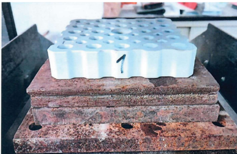
Prova 1 - modalità di applicazione del carico, il provino sotto la pressa prima della prova Test 1 - load application mode, the sample under the press before the test
